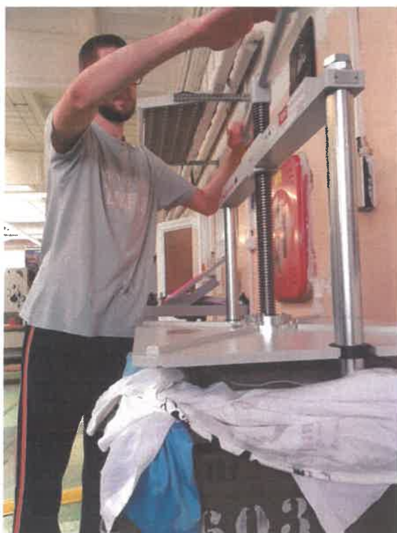
Lisování v ručním vřetenovém lisu.
